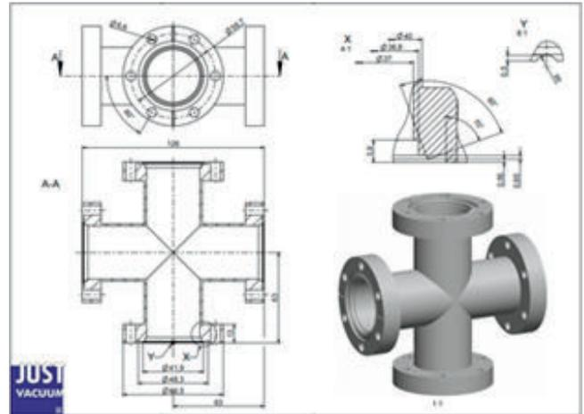
**JUST VACUUM** setzt verschiedene Verfahren zur Oberflächenbearbeitung wie Beizen, Glasperlenstrahlen und Elektropolieren ein, zudem wird auf höchste Sauberkeit geachtet. Alle Vakuumkammern werden in Lecktests auf Dichtheit bis  $10^{-10}$  mbar l/s geprüft und vorzugsweise blindgeflanscht in Folie verpackt.
